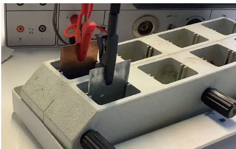
Abb. 1: Dieses Experiment kennen wir bereits: Der Nachbau des Daniell-Elements.
