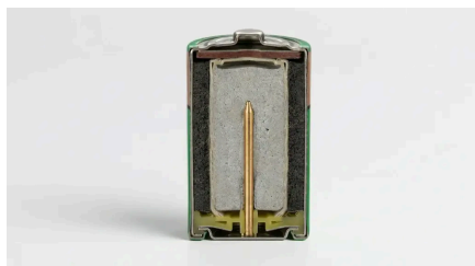
Abb. 2: Querschnitt durch eine Alkali-Mangan-Batterie. 1
