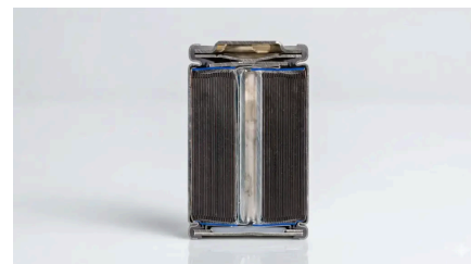
Abb. 6: Querschnitt durch eine Rundzelle mit Sandwich-Struktur (Jelly Roll). 1
