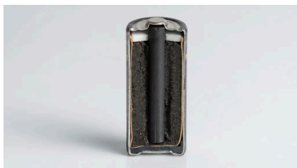
Abb. 4: Querschnitt durch eine Zink-Kohle-Batterie. 1
