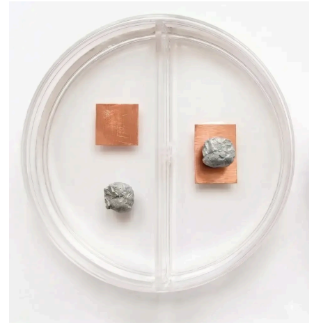
Abb. 2: Versuchsaufbau. In der linken Petrischalen-Kammer liegt eine Zink-Granalie und ein Stück Kupfer-Blech nebeneinander. In der rechten Kammer liegen diese aufeinander. Beide Kammern sind mit Salzsäure gefüllt. 1
